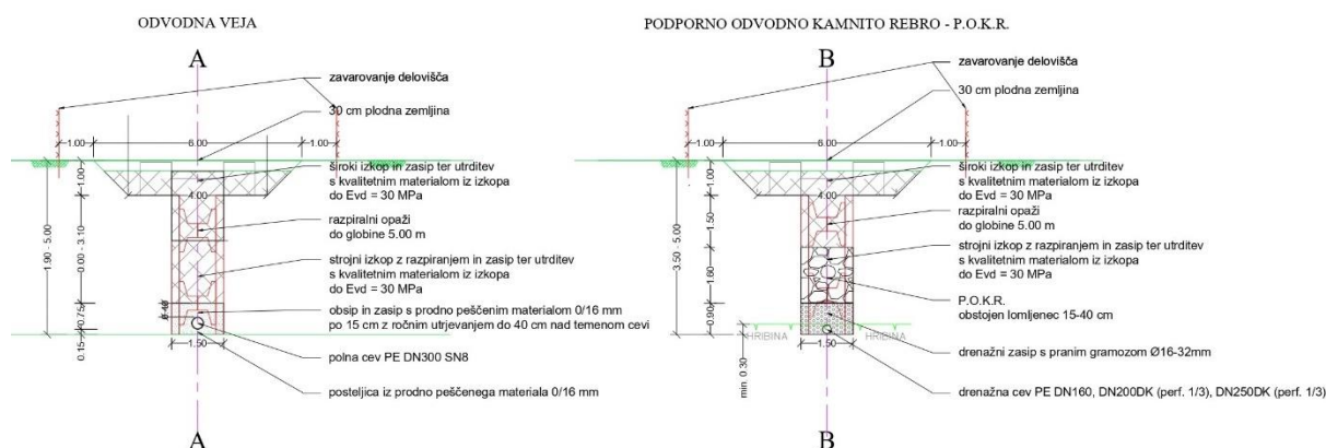
Slika 6: SHEMA ODVODNJAVANJA IN KAMNITEGA REBRA
